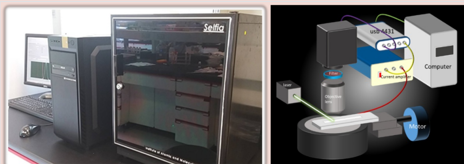
圖2.自旋增強側流免疫分析儀（左）及其設計示意圖（右）。
